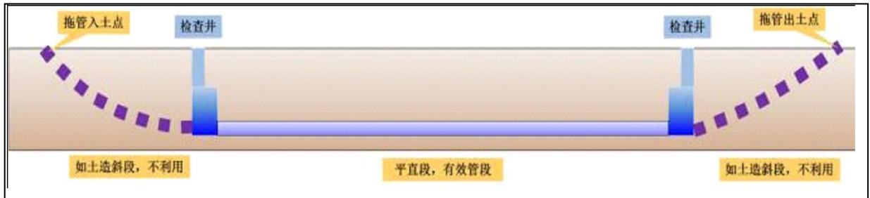
图2.3-3 牵引管施工示意图
